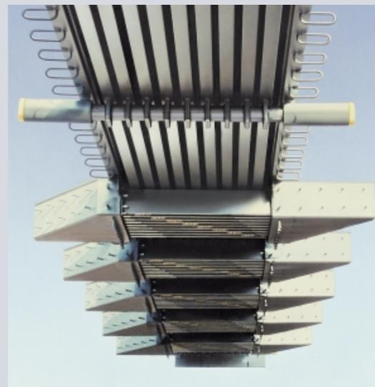
Die Bemessung und konstruktive Ausbildung der Dehnfugen erfolgt in Deutschland insbesondere nach der Technischen Liefer- und Prüfvorschrift des Bundesverkehrsministeriums TL/TP-FÜ. MAURER Trägerrost-Dehnfugen sind nach dieser Vorschrift regelgeprüft und fremdüberwacht. Für die Ermittlung der Bewegungen sind nach DIN 1072 in ungünstiger Kombination folgende Einflüsse zu berücksichtigen:
